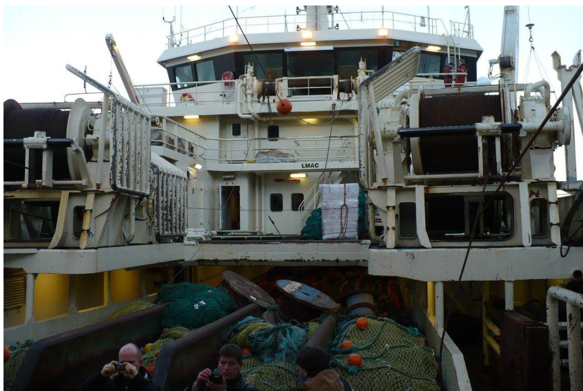
Bilde 5 Norsk torsk-/reke-tråler med vinsjustrustning og trålbåner for trippeltrål
