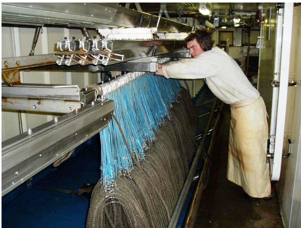
Bilde 2 Arbeid med magasiner ved mekanisert linedrift ombord på banklinebåt
